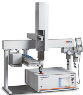
气相离子迁移谱与热解吸技术相结合
